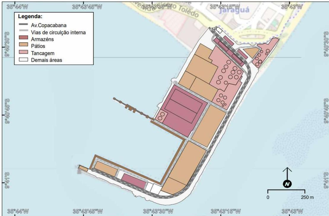
Figura 22 – Configuração das instalações de armazenagem no horizonte de curto, médio e longo prazo
