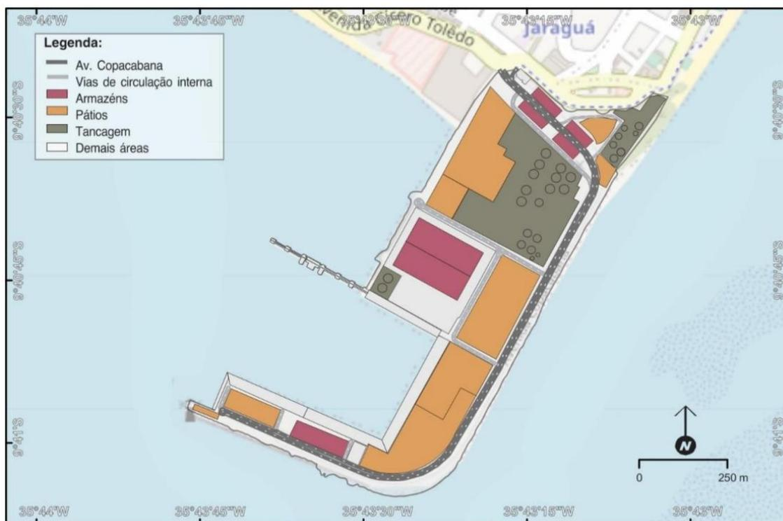
Figura 30 – Configuração das instalações de armazenamento no Porto de Maceió.
